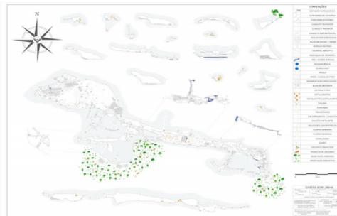
Figura 2 – Exemplo de mapa espeleológico produzido em plataforma AutoCAD. Gruta Igreja, Ouro Preto – MG. Fonte: Elaborado pelos próprios autores.
