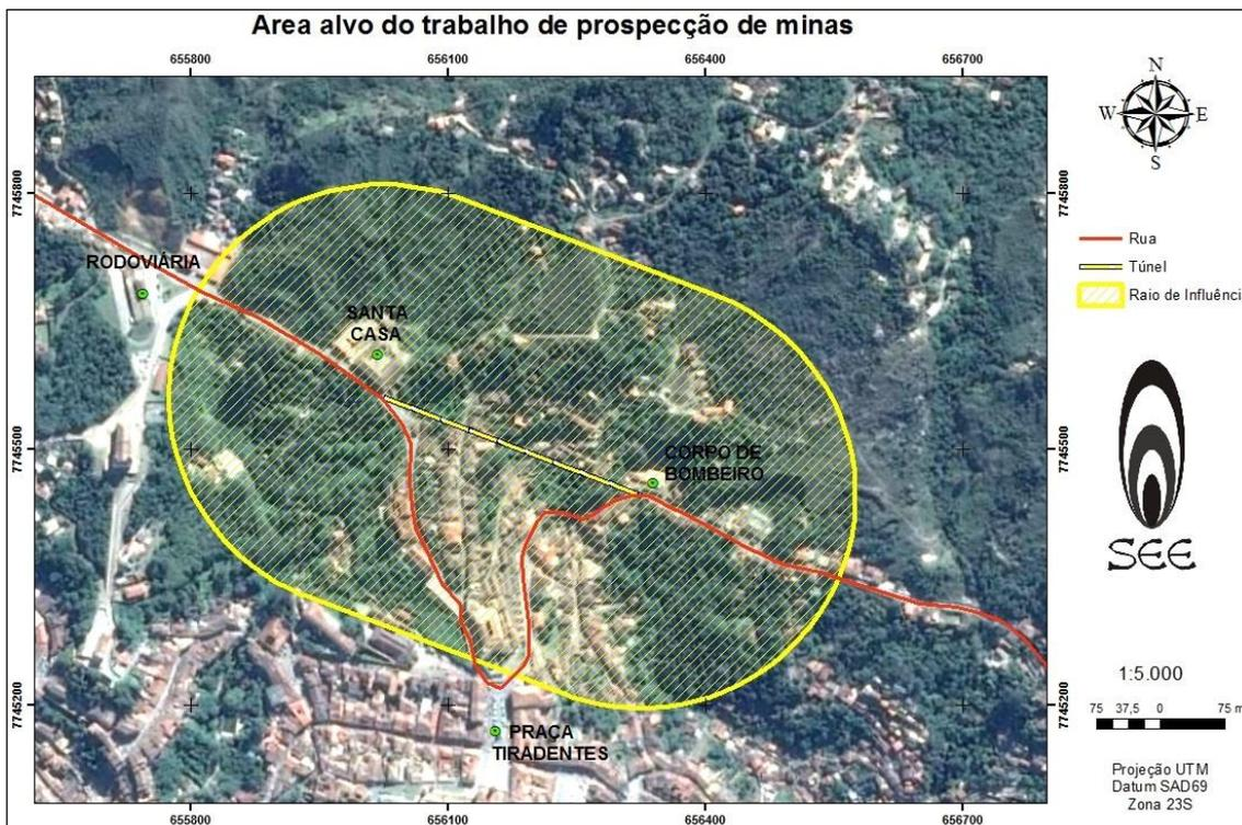
**Figura 2-16:** Localização de um possível eixo para o túnel previsto e raio de influência sobre minas. Fonte: SEE
